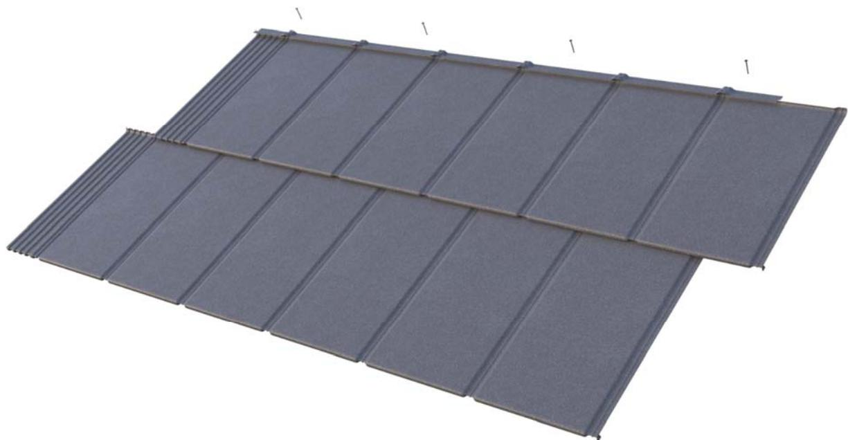
Для крепления можно использовать гвозди длиной 35 мм, рифлёные, шляпкой диаметром от 9 мм. Например, гвозди ИКО
